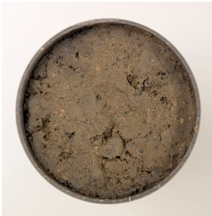
Figur 8. Överytan på en stabiliserad provkropp.
