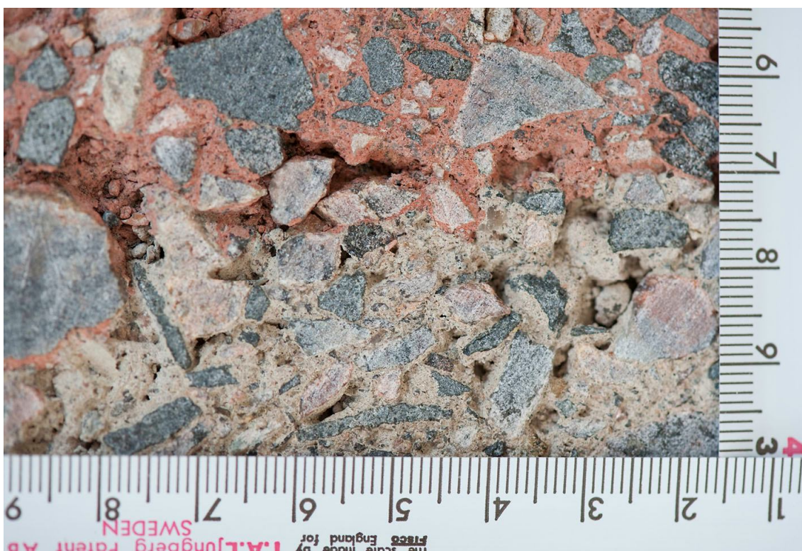
Figur 13. Foto visande inre porstrukturer uppkomna i samband med tillverkning.
