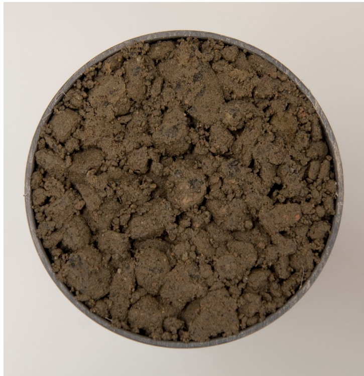
Figur 7. Underytan på en stabiliserad provkropp.
