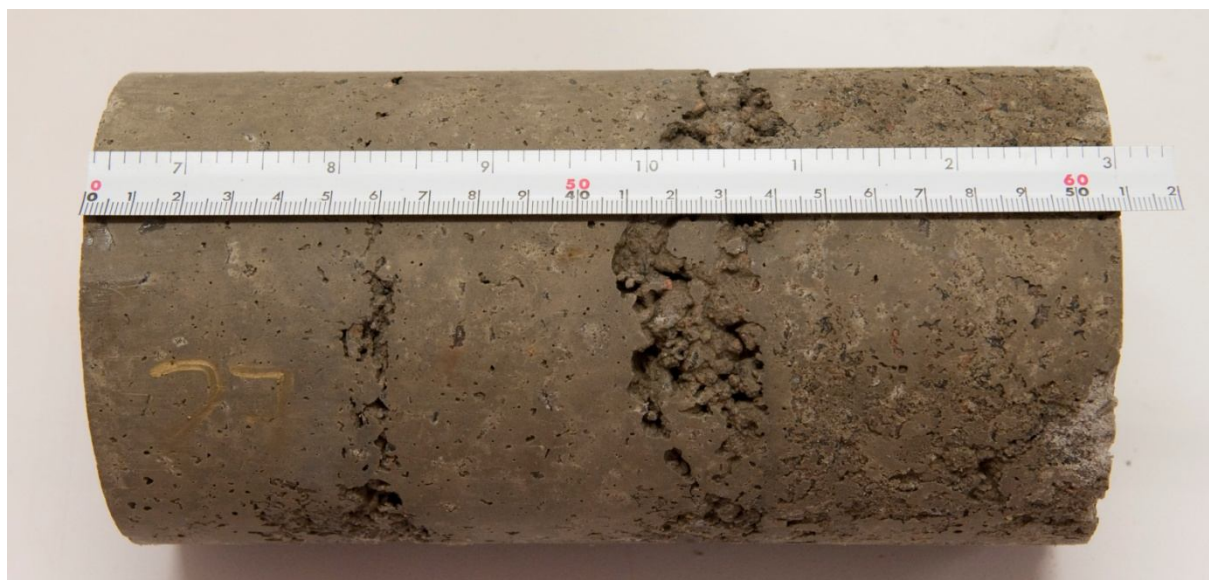
Figur 10. Provkropp 27. Provkroppen innehåller 1/3 cement, 1/3 kalk och 1/3 energiaska. Provkroppen uppvisar ett porsystem vid packningsgränserna.
